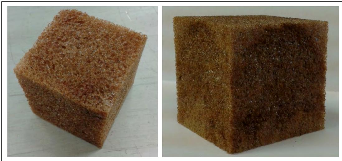
Abb. 220: Polyurethanschäume auf Basis von Organosolv-Lignin (Quelle: Uni-HH/TI)
