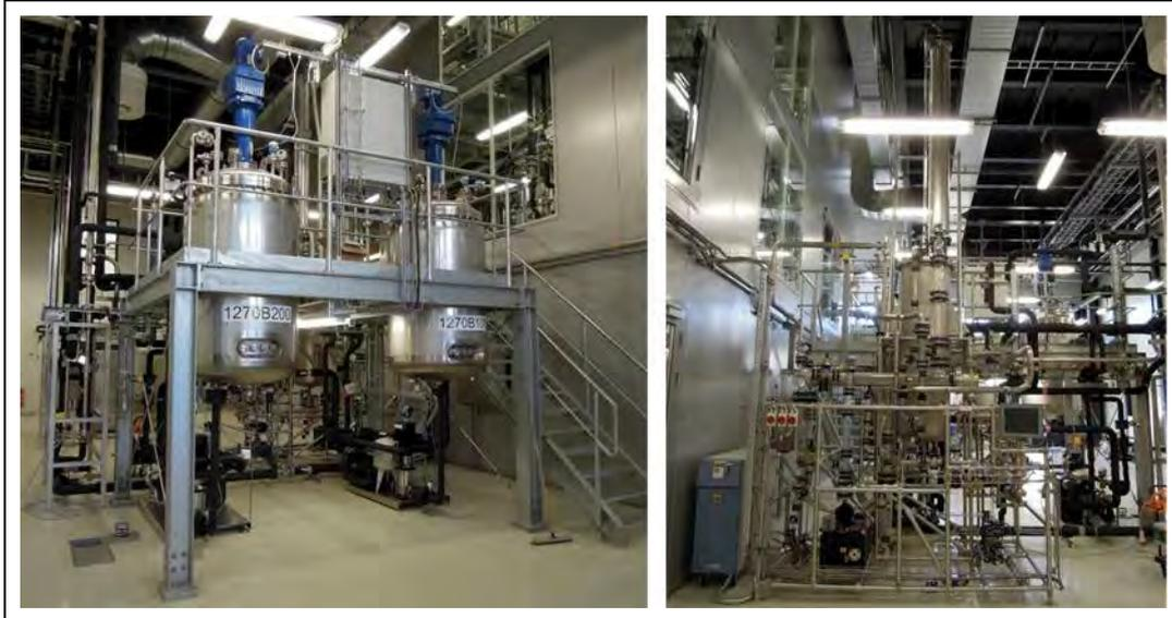
**Abb. 75: Links: TA 1270 Cellulosehydrolyse** mit den beiden Rührreaktoren. **Rechts: TA 1280 Eindampfung** (Quelle: CBP)
