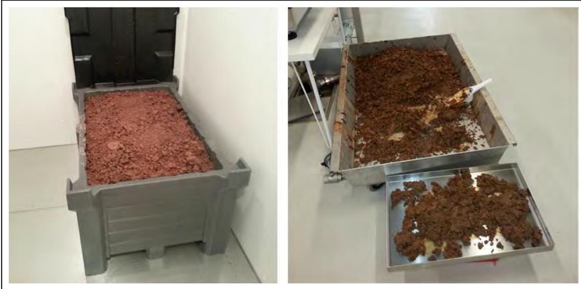
**Abb. 79: Gewonnene Fraktionen des ersten Holzaufschlusses der LCB-Pilotanlage.**
