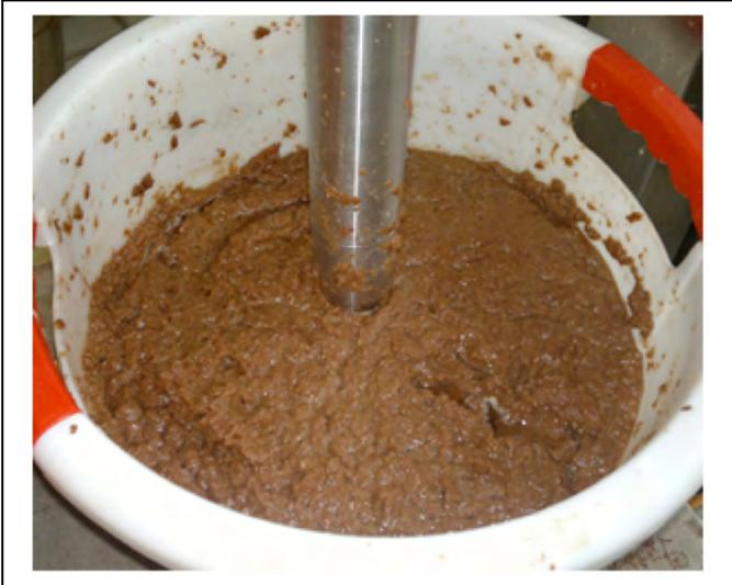
**Abb. 47: Organosolv-Fasern nach der Zerkleinerung** (Quelle: BTS)
