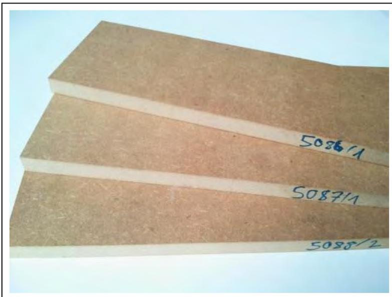
Abb. 143: Faserplatten der Laborversuchs-Bindemittel mit 10 % bzw. 20 % Phenolsubstitution sowie unmodifizierte Referenz (Quelle: Dynea)
