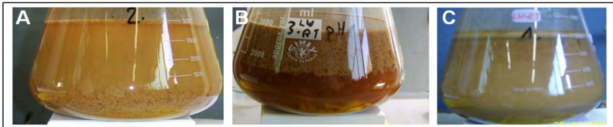
**Abb. 53: Fällung von je 1 L Ablauge in 2 L Wasser.** (A) in Leitungswasser bei Raumtemperatur (Probe 2), (B) nach Ansäuern der Ablauge auf pH 1 (Probe 3), (C) mit warmer Ablauge (Probe 1) (Quelle: Uni-HH/TI)
