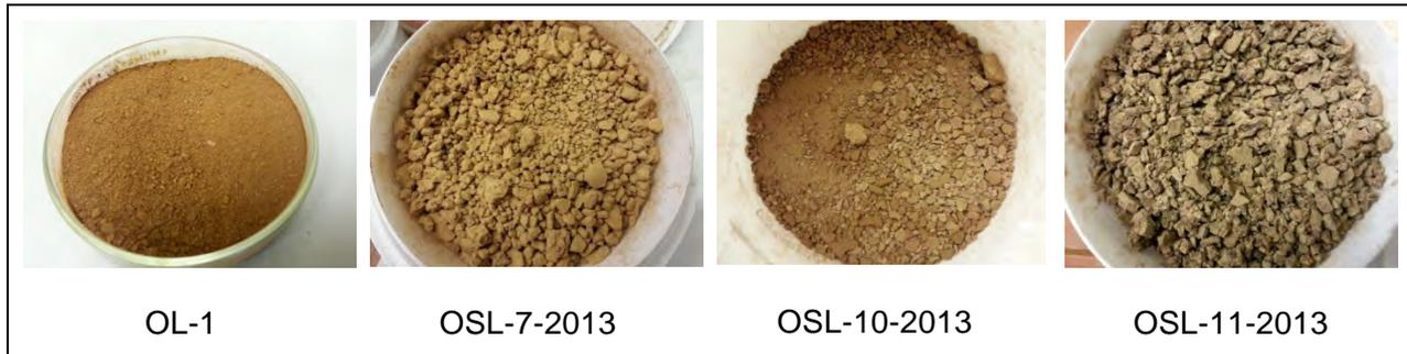
**Abb. 124: Fraktionen von Organosolvlignin (Labor und Pilotanlage)** (Quelle: Dynea)
