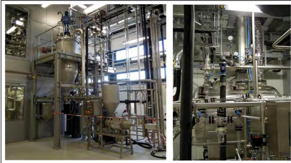
**Abb. 74: Links: TA 1240 Cellulosewäsche und -entwässerung** mit Waschbehälter und Schneckenpresse. **Rechts: TA 1250 Lösemittelrückgewinnung** mit Destillationssumpf, Verdampfer und unterem Kolonnenteil (Quelle: CBP)
