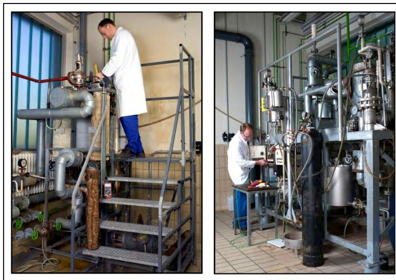
**Abb. 1: Aufschluss im Uni-HH/TI Technikum im 1-kg- (links, Viertopfkocher) und im 6-kg-Maßstab (rechts, 30-L-Kocher)**
