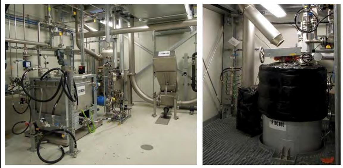
**Abb. 71: Teilanlage 1210 Holzaufschluss.** Links: atmosphärischer Vorlagetank B200 mit Hochdruckpumpe sowie Holzaufgabe Rohrkettenförderer. Rechts: Aufschlussreaktor C100. (Quelle: CBP)
