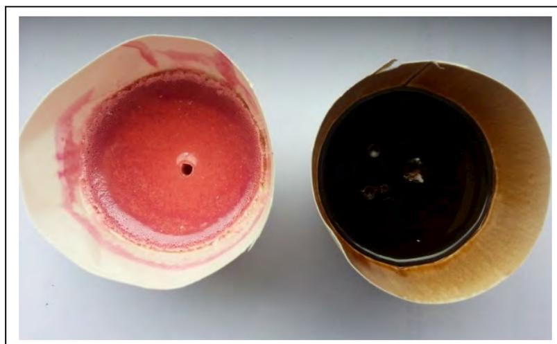
**Abb. 185: Farbunterschied zwischen unmodifiziertem (links) und Lignin-haltigem Schaumharz (20 %, rechts) (jeweils gehärtet ohne Treibmittel) (Quelle: Dynea)**
