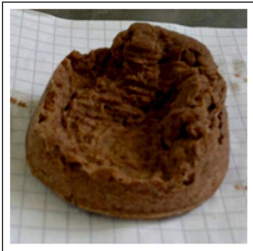
**Abb. 52: Cellulose-Faserkuchen nach Filtration** (Quelle: BTS)
