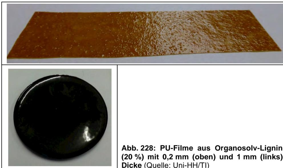
**Abb. 228: PU-Filme aus Organosolv-Lignin (20 %) mit 0,2 mm (oben) und 1 mm (links) Dicke (Quelle: Uni-HH/TI)**
