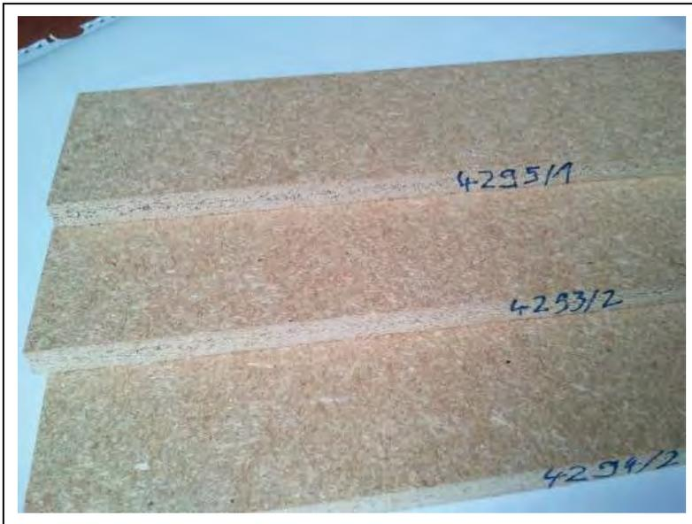
Abb. 153: Spanplatten der Laborversuche-Bindemittel mit 10 % bzw. 20 % Phenolsubstitution sowie unmodifizierte Referenz (Quelle: Dynea)
