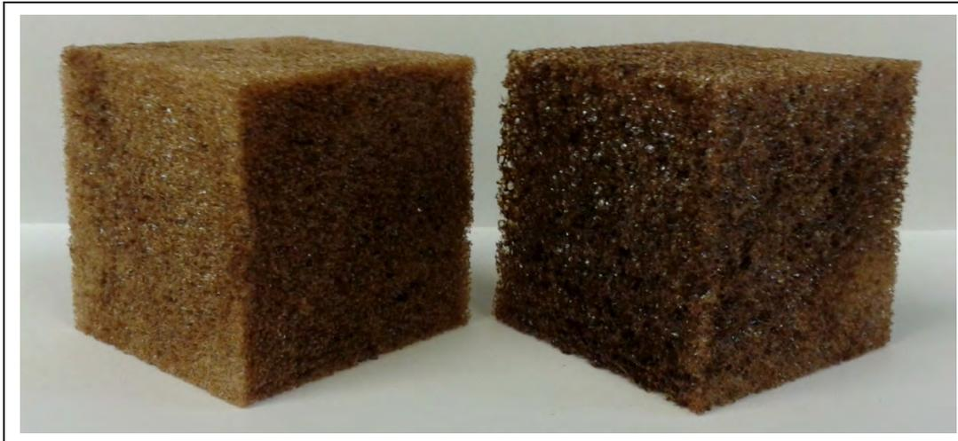
**Abb. 224: Polyurethanschäume aus Organosolv-Lignin (links) und hydroxypropyliertem Organosolv-Lignin (Quelle: Uni-HH/TL)**
