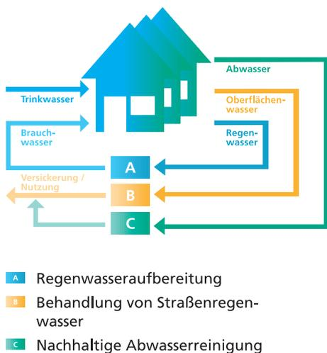
**Bild 1:** Schematische Darstellung der Wasserkreisläufe im Neubaugebiet »Am Römerweg« in Knittlingen.
