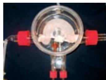
**Bild 4:** Vaskularisierte Matrix, eingesetzt in einen Bioreaktor. Dieser hat einen Anschluss zur Perfusion der vaskularen Strukturen von unten; über einen zweiten, seitlichen Kreislauf kann Medium zugeführt werden.
