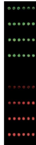
**Bild 2:** Fluoreszenz-Scan eines Nanopartikel-Microarrays nach Inkubation mit fluoreszenzmarkierten Analyten. Die pro Spot übertragene Partikelmenge nimmt jeweils von oben nach unten zu, entsprechend wächst die Menge gebundenen Analyts und damit das Fluoreszenzsignal.
