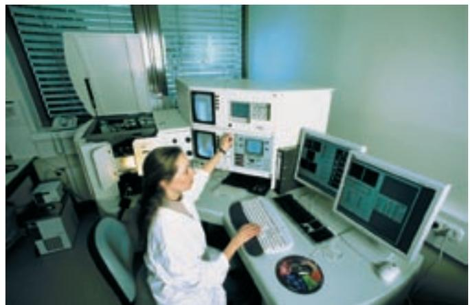
**Bild 3:** Sortierung und Separation spezifischer Zellpopulationen aus Geweben und Organen über ein FACS-Vantage.
