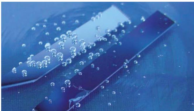
**Gelangt UV-Strahlung auf photokatalytisch aktive Oberflächen, werden Radikale erzeugt, welche Schadstoffe im Wasser abbauen können. Das Bild zeigt eine photokatalytisch beschichtete Probe unter Wasser. Durch die Photokatalyse wird Wasser in Sauerstoff und Wasserstoff gespalten.**
