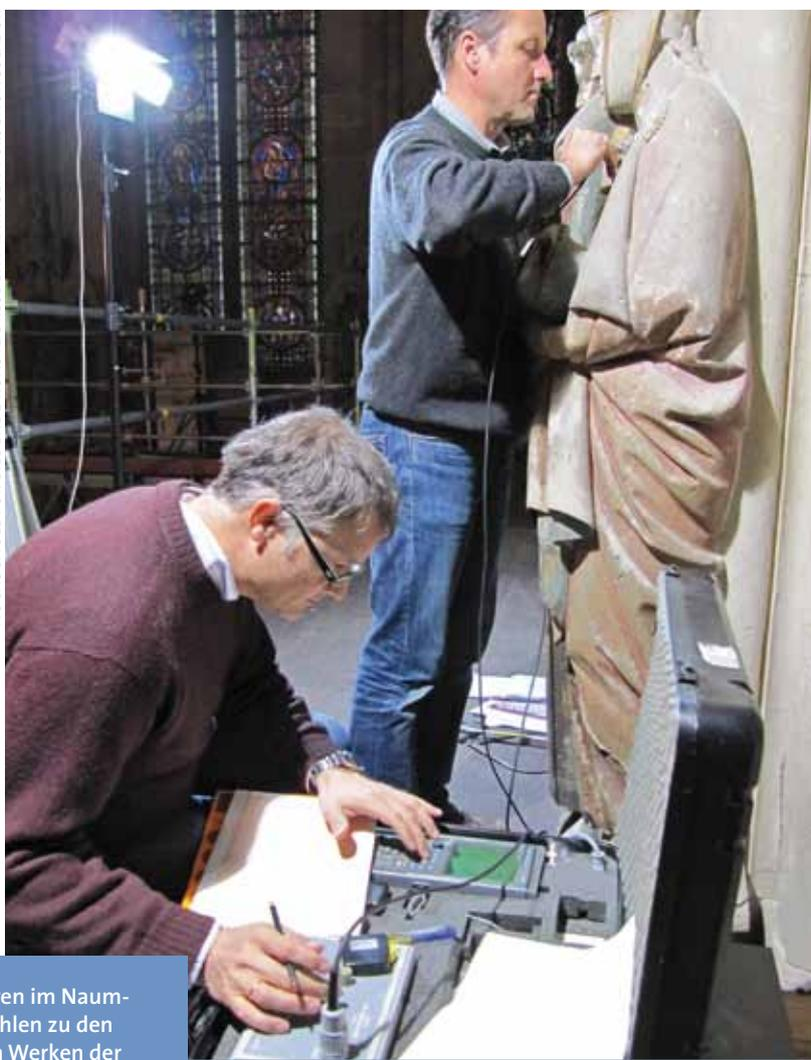
Die dabei verwendeten Ultraschallwandler bestehen aus einzelnen Elementen, die getrennt voneinander angeregt und ausgelesen werden können. Indem die Elemente zu unterschiedlichen Zeitpunkten Schallimpulse verschiedener Intensität aussenden, wird der Fokus einer Schallkeule in einer Schnittebene elektronisch bewegt und erlaubt so die Abbildung der Ebene.
