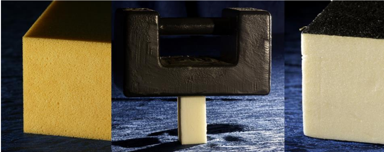
Abbildung 180: Polyurethanschäume: Die wahrscheinlich wichtigste Anwendung für Polyurethane sind Schäume (oben links Weichschaum, Mitte Hartintegralschaum und rechts Isolationsschaum).
