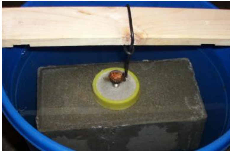
Abbildung 174: Beschichteter Betonklotz, nach ca. 3 Monatiger Lagerung im Wasserbad.
