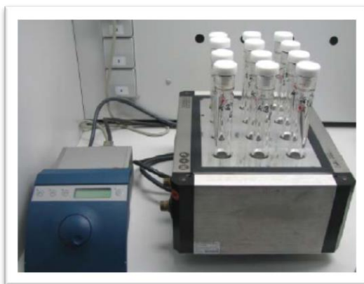
Abbildung 59: HT-Screening-Geräte mit Hochdruckschläuchen.
