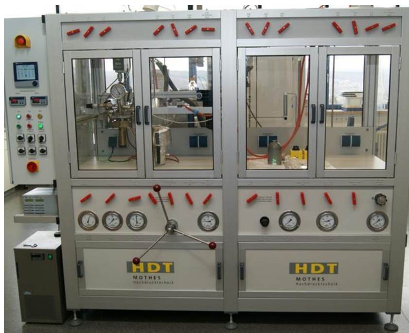
Abbildung 55: Apparatur für die Arbeiten mit gasförmigem Ammoniak. Im linken unteren Bereich sind der Kryostat zum Einkondensieren flüssigen Ammoniaks, sowie der Handgriff der Spindelpumpe zu erkennen.
