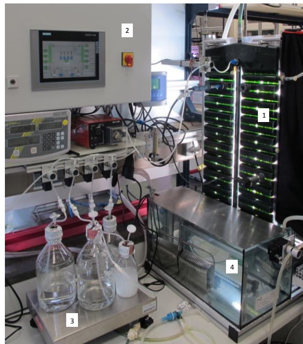
Abbildung 2: Kultivierungsstand für die Wachstumsphase von Chlorella sorokiniana . 1: 6-Liter FPA-Reaktor, 2: SPS-Steuerung, 3: Waage mit Fütterungslösungen, 4: Wasserbad für die Kühlung/Beheizung des Reaktors.
