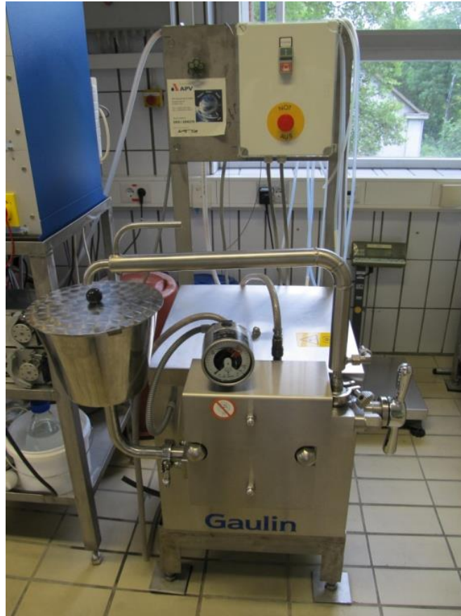
Abbildung 28: Hochdruckhomogenisator der Fa. APV/Gaulin, Modell LAB40-10,0 RBF1, zur Untersuchung des Zellaufschlusses von Chlorella sorokiniana .
