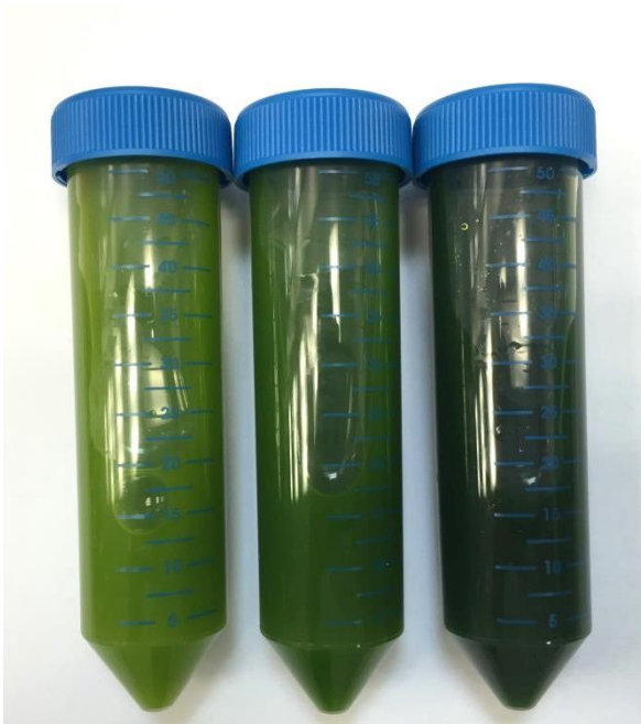
Abbildung 13: Proben aus den Reaktoren der zweiten Limitierung am siebten Tag nach der Inkulation. Biomassestartkonzentrationen von links nach rechts: 1,5 g/L; 3 g/L (Reaktor hatte zu Beginn des Versuchs eine Leckage) und 6 g/L
