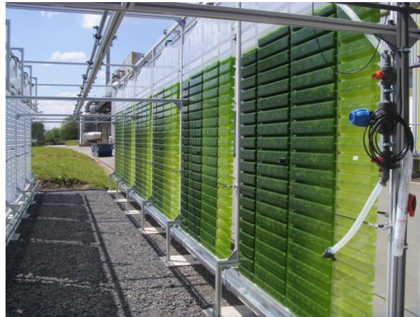
Abbildung 61: 180 L FPA-Photobioreaktoren während der Inokulation. Die Integration der Hach Lange Trübungssonde war über einen Bypass (rechter Bildrand) möglich.
