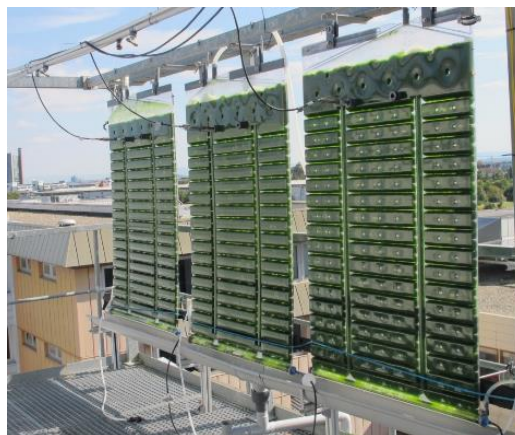
Abbildung 5: Stärkeproduktionsreaktoren der Freilandanlage zur Algenkultivierung im Fraunhofer IGB
