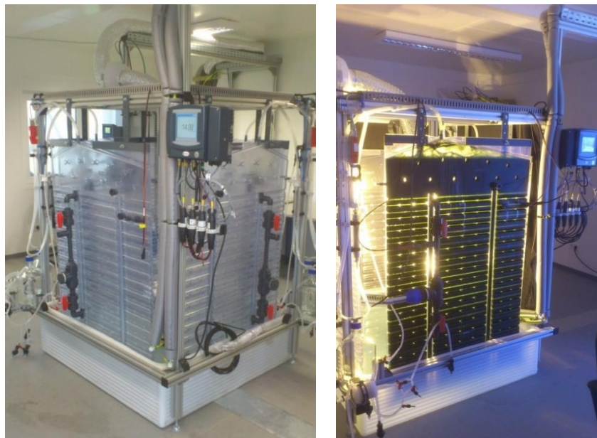
Abbildung 17: Technikumsanlage bestehend aus vier 28 L FPA-Photobioreaktoren zur Kultivierung phototropher Mikroorganismen nach Montage und Inokulation mit C. sorokiniana SAG 211-8k.
