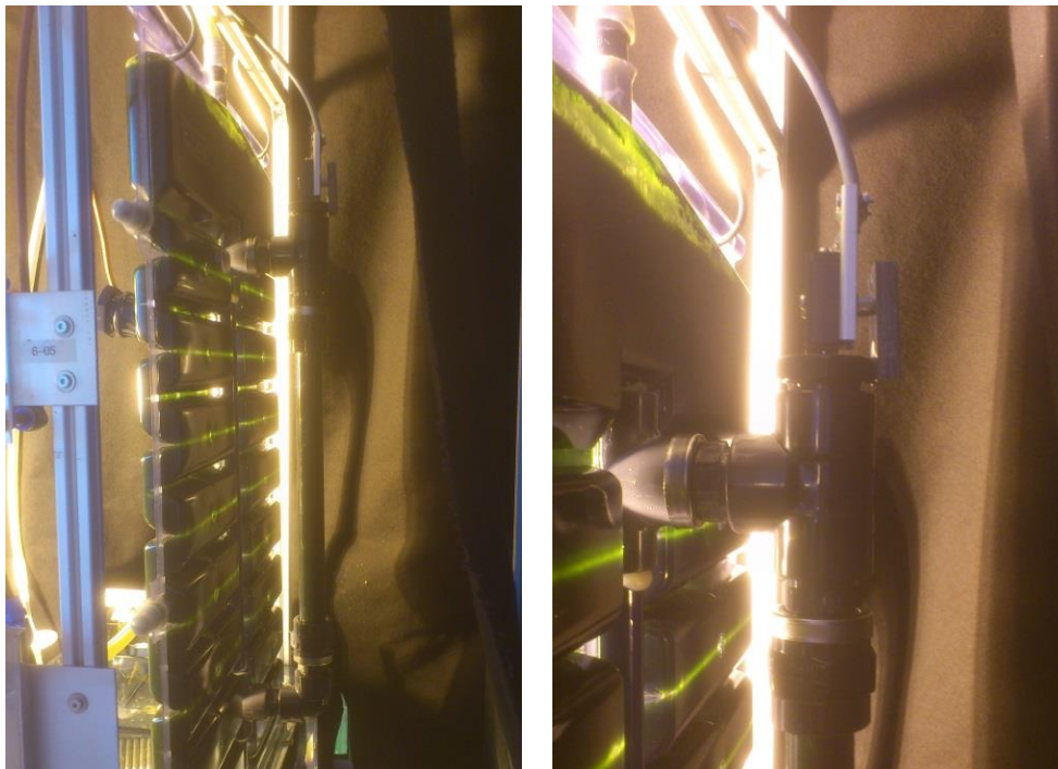
Abbildung 26: Integration der PAM-Sensorik (invasiv) an ein 6 L FPA-Photobioreaktorsystem über einen Bypass mit intermittierender Begasung an der lichtabgewandten Seite.
