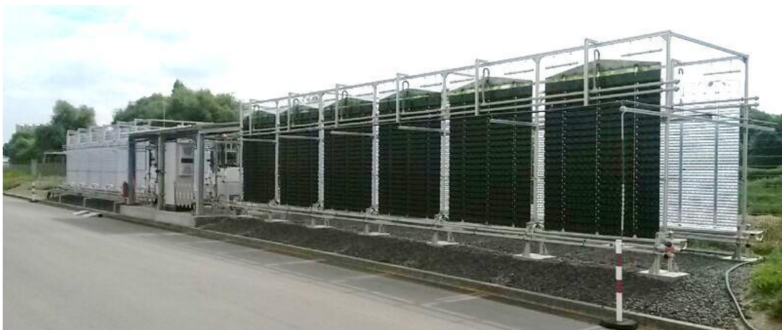
Abbildung 51: Freilandanlage bestehend aus vier Linien mit jeweils sechs 180 L FPA-Photobioreaktoren zur Kultivierung phototropher Mikroorganismen nach Inokulation mit C. sorokiniana .
